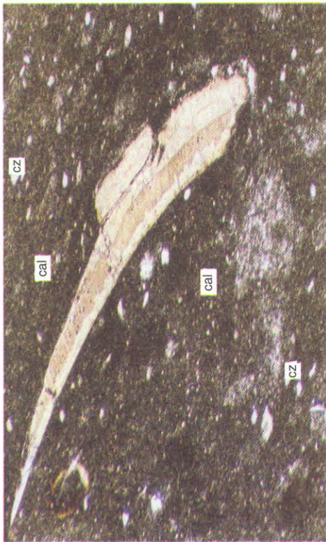
Microfoto N° 4.5 Nódulo de caliza micrítica en la Fm. Pebas, (Y-990312) recolectada en las inmediaciones de la margen derecha del río Motahuayo. Se aprecia un resto fósil de valva de lamelibranchio, parcialmente dolomitizado, cemento calcáreo (cal) y fragmentos de cuarzo (cz). Nícoles paralelos. Aumento x75.
