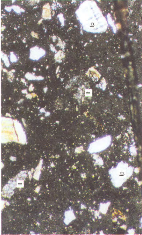
Microfoto N° 4.6 Arenisca subarcósica de la Fm. Ipururo, (MA-990418) recolectada en las cercanías del poblado de 200 Millas, margen derecha del río Napo. Se observan cuarzo (cz), feldespatos (fp) y líticos (lt). Nícoles cruzados. Aumento x75.
