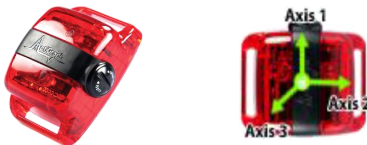
Figura 2. Sensor empleado: GT3X ActiGraph y orientación de sus ejes [1].
