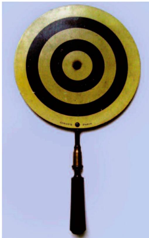
**Figura II-4:** Disco de Placido. Queratoscopio manual con anillos concéntricos y mira central. Creado por Antonio Placido. Foto tomada de un artículo de Grzybowski (142).
