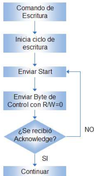
Diagrama de flujo para acknowledge polling Fuente: Hoja de datos 24LC256
