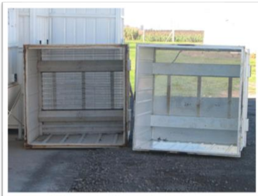
Foto 16. Detalle de celdas para secadora de aire forzado, con piso de reja.
