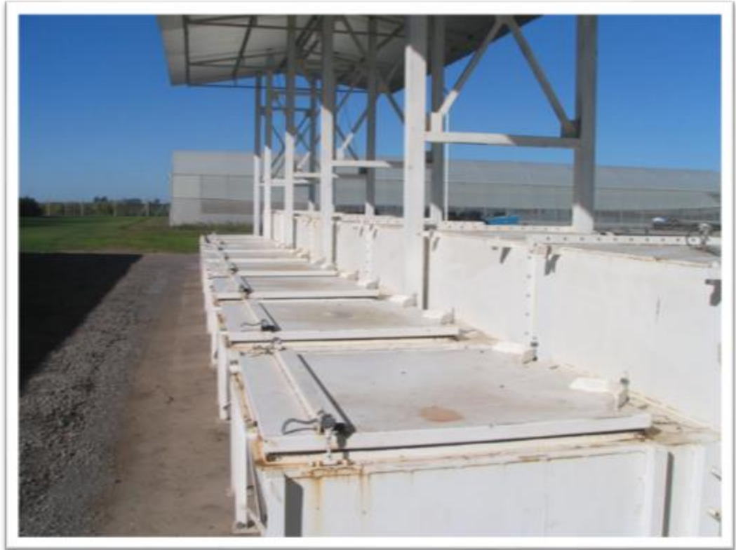
Foto 17. Detalle de salidas de aire de la secadora de aire forzado.
