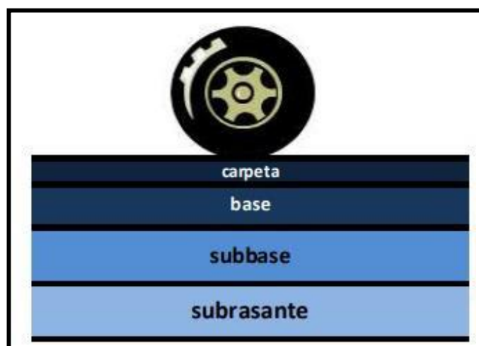
Figura 1. Componentes del pavimento flexible.
