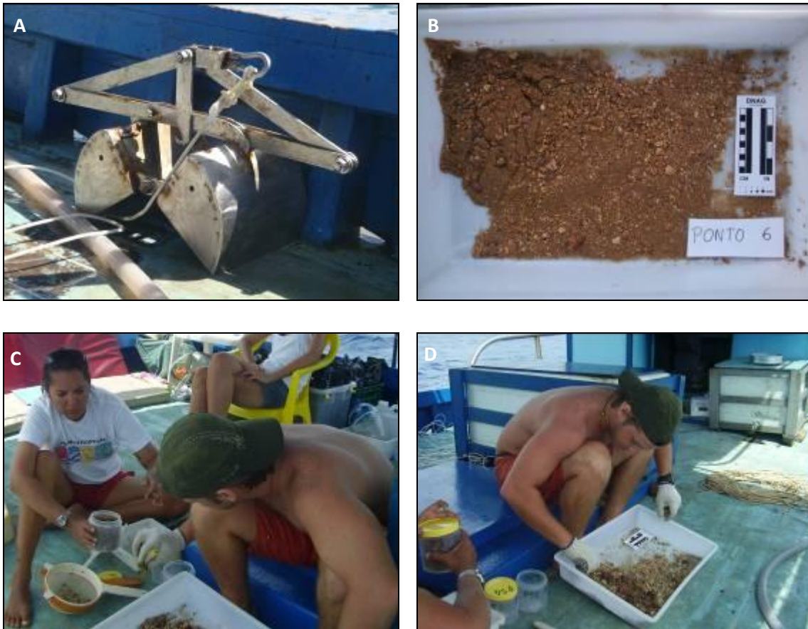
FIGURA 4.2-2 - A – Amostrador busca-fundo; B - Amostra de material coletado; C - Separação das amostras; D - Acondicionamento das amostras.
