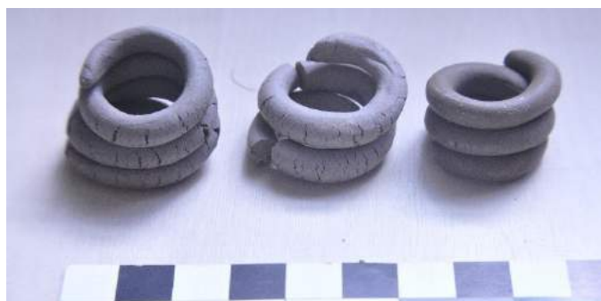
Figura 6: Teste de plasticidade com rolos em espiral com três argilas distintas. Produtora: Lara Passos. Foto: Lílian Panachuk.
