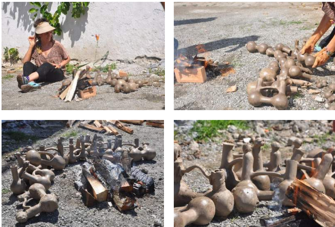
Figura 63: Processo de secagem e esquentas das peças. Fotos: Laila Kierulff.
