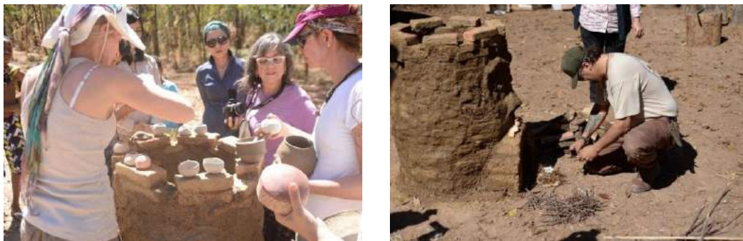
Figura 71: Montagem das peças no forno de tijolo, fogo acendido por “atacante”. Fotos: Daniel Cruz.
