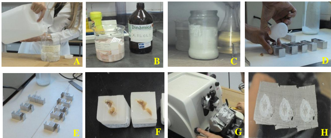
Figura 9 – Processamento das amostras – rotina histológica. (A) Desidratação; (B) Diafanização; (C) Parafinização; (D) Emblocamento; (E) Solidificação da parafina; (F) Blocos com as amostras; (G) Realização dos cortes histológicos no micrótomo e (H) Cortes histológicos da amostra na lâmina
