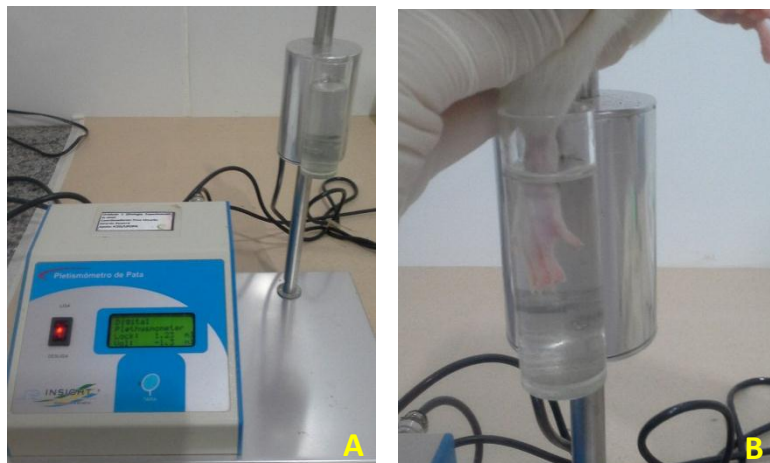
Figura 10 – (A) Pletismômetro digital; (B) Imersão da pata do animal.
