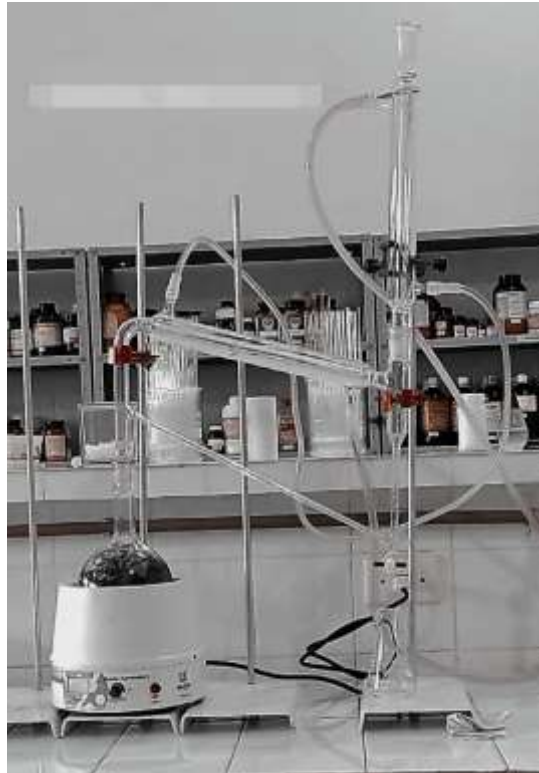
Figura 9: Extração de óleo essencial em aparelho de Clevenger.
