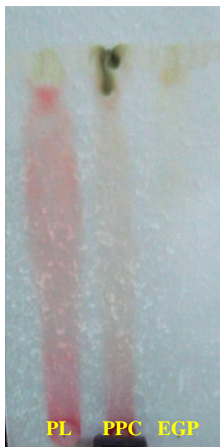
FIGURA 06: Cromatograma para a identificação de proantocianidinas condensadas e leucoantocianidinas. EGP: Extrato metanólico das cascas da raiz de G. platypoda ; PL: Padrão leucoantocianidinas; PPC: Padrão proantocianidinas condensadas
