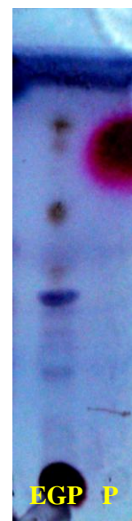
FIGURA 03: Cromatograma para a identificação de monoterpénóides, sesquiterpenóides e diterpenóides. EGP: Extrato metanólico das cascas da raiz de G. platypoda ; P: Padrão
