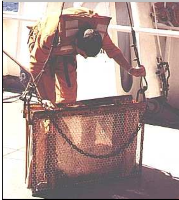
Figura 3. Amostrador draga utilizado durante as coletas da macrofauna bentônica no Programa Revizee/Score NE.
