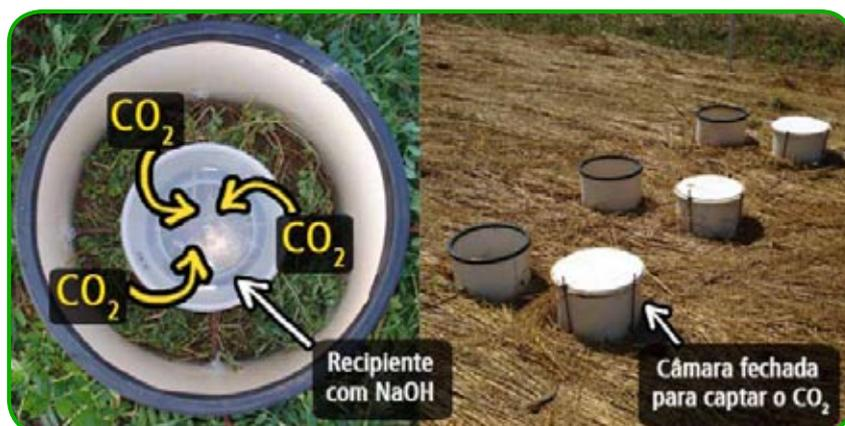
**Figura F.7.** Dispositivo utilizado para avaliar a mineralização do carbono em condições de campo.
