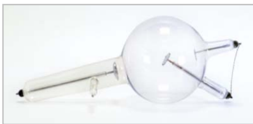
Figs. 143 e 144: Instrumentação existente no Gabinete de Física Experimental da Universidade de Coimbra: uma ampola de raios-X (FIS.1185) e uma bobina de Ruhmkorff (FIS.0315), respectivamente. ( http://www.museudaciencia.org )
