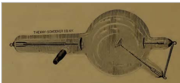
Fig. 40: Um modelo de tubo de foco. (THE KNY-SCHEERER COMPANY 1905)
