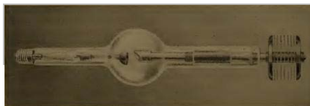
Fig. 52: Tubo de Coolidge, tipo Radiador. (GENERAL ELECTRIC COMPANY 1920)
