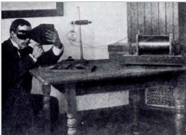
Fig. 120: Um dos primeiros métodos de calibração dos raios-X produzidos, inferido através da imagem resultante do exame radioscópico à mão do operador (1896). (FELDMAN 1989)
