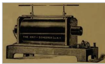
Figs. 61 e 62: Bobinas de indução do princípio do século XX. (THE KNY-SCHEERER COMPANY 1905)
