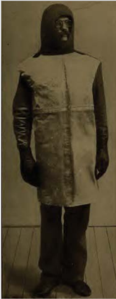
Fig. 138: Fato protector de raios-X do início do século XX. Era feito de borracha coberta com folha de chumbo, assim como as luvas, capuz e avental. Os óculos eram de vidro com chumbo. (THE KNEE-SCHEERS COMPANY 1905)
