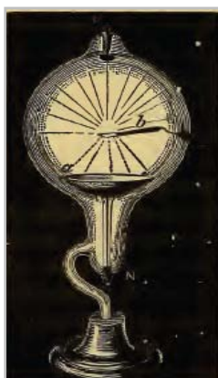
Fig. 43: Protótipo de um tubo de foco, proposto por Crookes em meados do século XIX. (CROOKES 1879)
