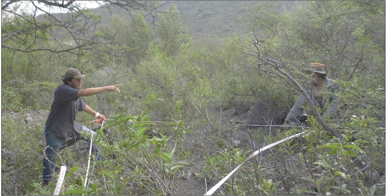
**Fig. 10:** Levantamiento de parcelas con wincha, estacas y rafia, empleando el método del triángulo rectángulo, tomando como punto inicial la coordenada establecida al azar en gabinete.
