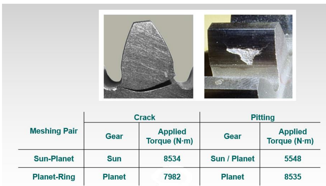
Figura 6: Valores de par necesarios para que aparezcan defectos en los dientes.
