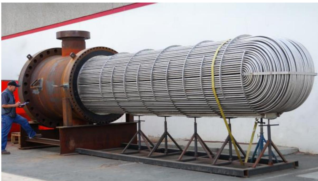
*Figura 16: Intercambiador de grandes dimensiones con la entrada a la carcasa*
