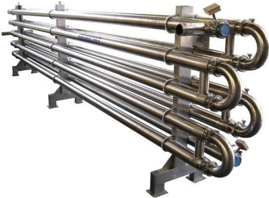
*Figura 8: Intercambiador tubular*
