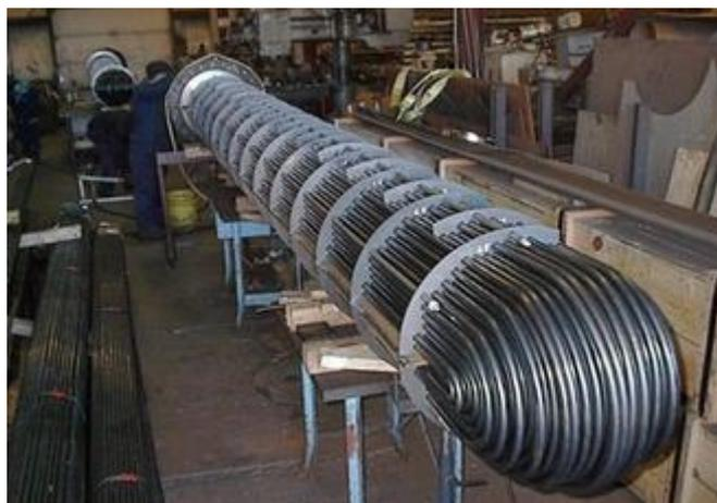
*Figura 15: Tubos en forma de U en el intercambiador*
