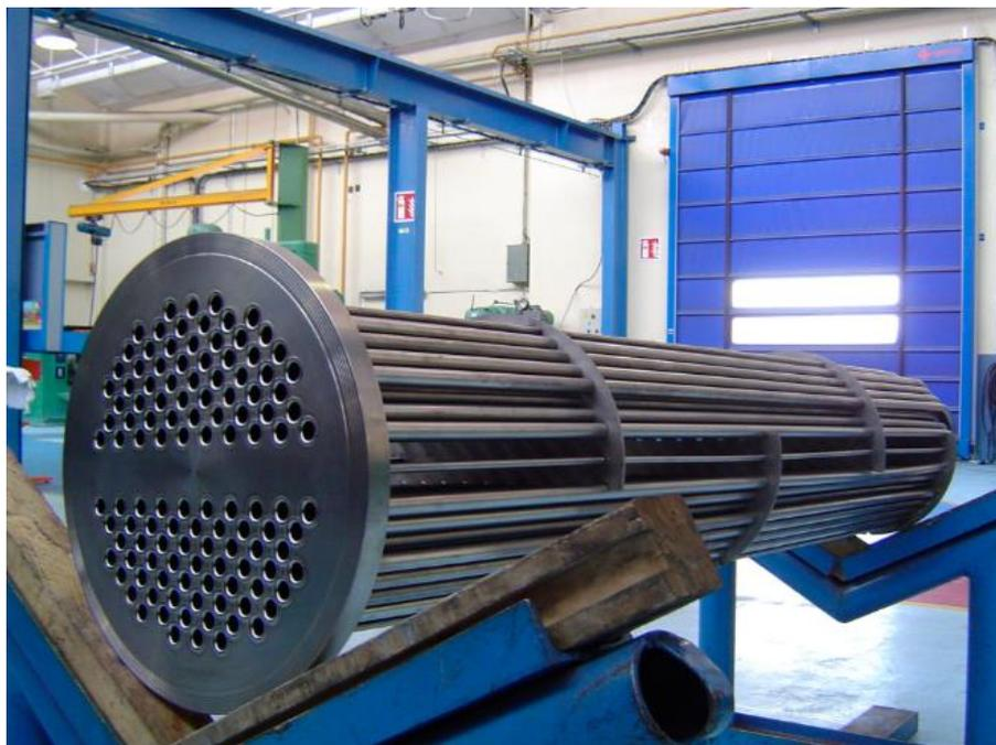
*Figura 13: Intercambiador sin carcasa*
