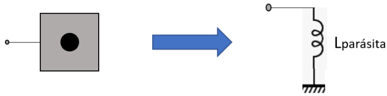
Figura 31. Efectos parásitos de agujeros a masa.
