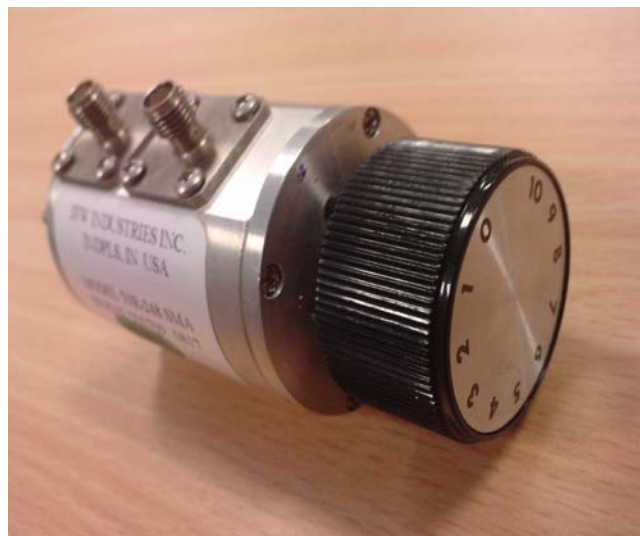
Detalle del atenuador variable con paso de 1 dB
