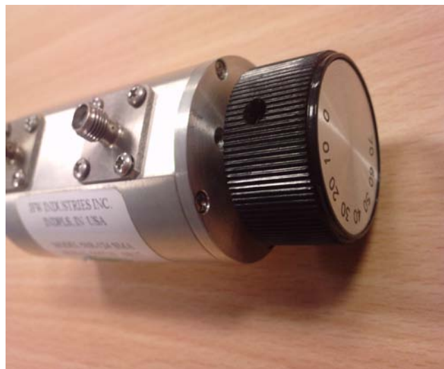
Detalle del atenuador variable con paso de 10 dB
