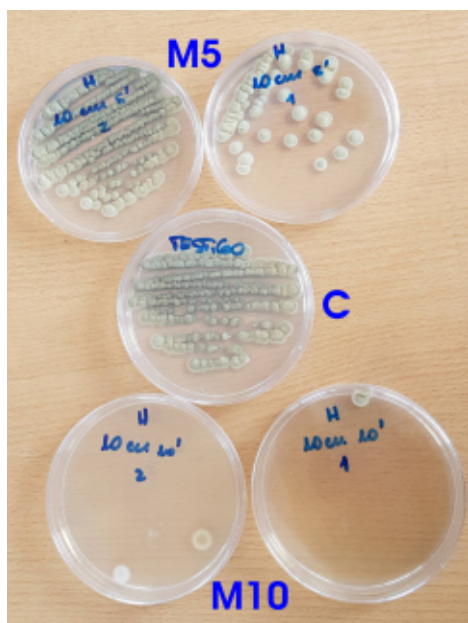
Figura 7. Cultivos de hongos irradiados con dispositivo LED UV-C 280 nm, durante 5 y 10 min (M5 y M10, respectivamente), con réplica, a una altura de 10 cm. Se observa el efecto de la irradiación UV-C, con una disminución en el desarrollo de hongos con el tiempo de irradiación 10 min, pero con menor efecto con el tiempo de irradiación 5 min. En el centro, el control sin irradiar.
