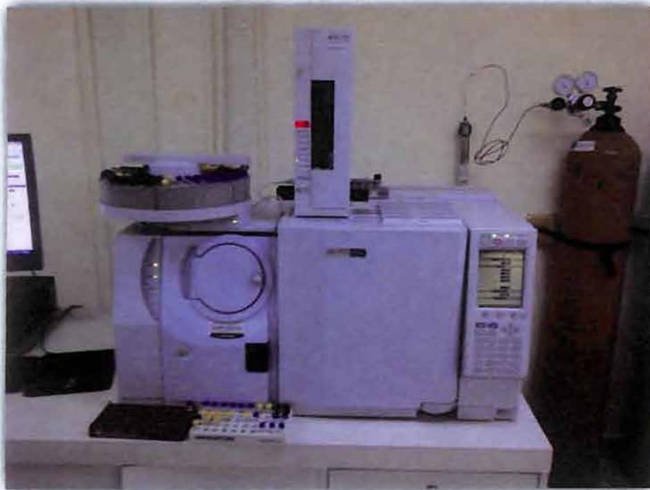
**Figura 2:** Cromatógrafo de Gases con Espectrometría de Masas (GC-MS)
