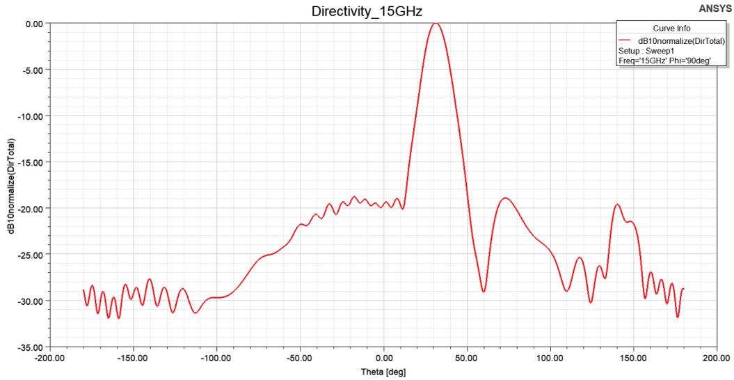
Figura 4.54: Diagrama cuando transmitimos del puerto 1 al 2 para 15 GHz
