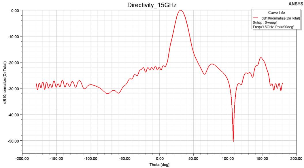
Figura 4.72: Diagrama cuando transmitimos del puerto 1 al 2 para 15 GHz
