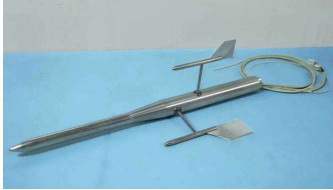
Figura 14: Sensor de velocidade e ângulos de ataque e derrapagem.
