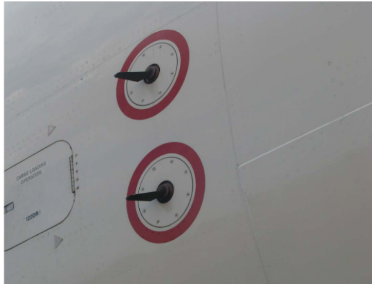
Figura 13: Sensor de ângulo de ataque de aeronave comercial.
