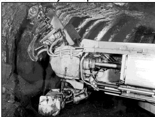
Figura 17 - Minerador contínuo Joy 1CM operando em mina de carvão nos EUA.
