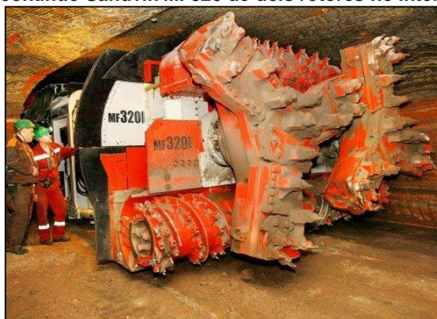
Figura 20 - Minerador contínuo Sandvik MF320 de dois rotores no interior de uma mina de sal.
