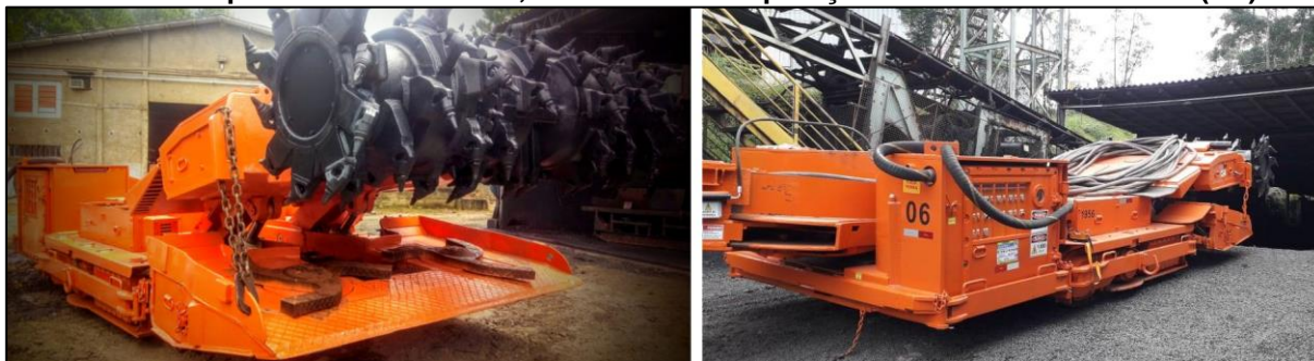
Figura 26 - Vista dianteira (esq.) e traseira (dir.) de um minerador contínuo Komatsu Joy 14CM09 adaptado da Rio Deserto, atualmente em operação na mina Cruz de Malta (SC).
