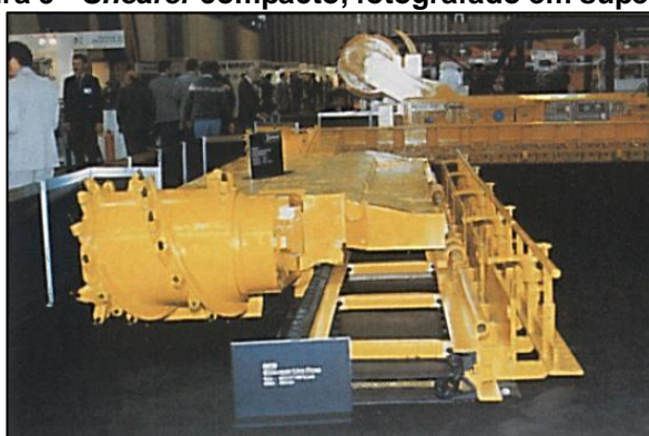
Figura 9 - Shearer compacto, fotografado em superfície.
