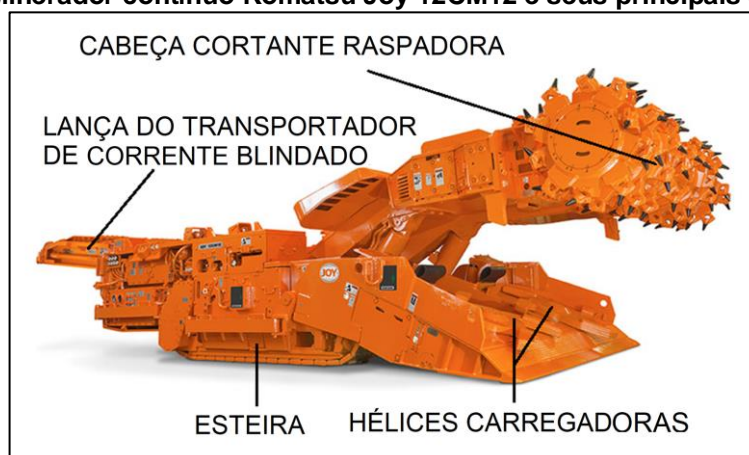
Figura 18 - Minerador contínuo Komatsu Joy 12CM12 e seus principais componentes.
