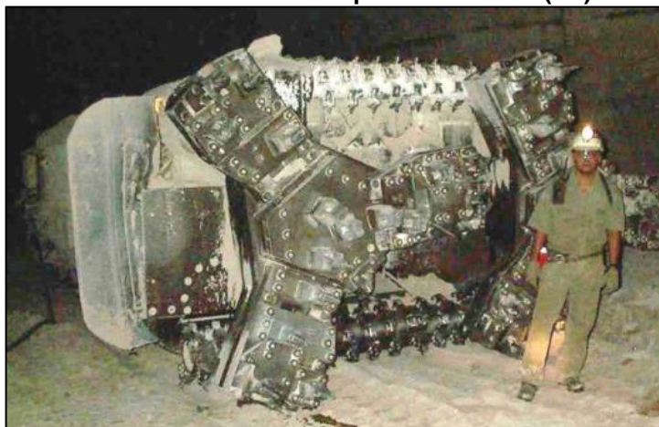
Figura 27 - Minerador Marietta 900 na mina Taquari-Vassouras (SE) – Mosaic Fertilizantes.
