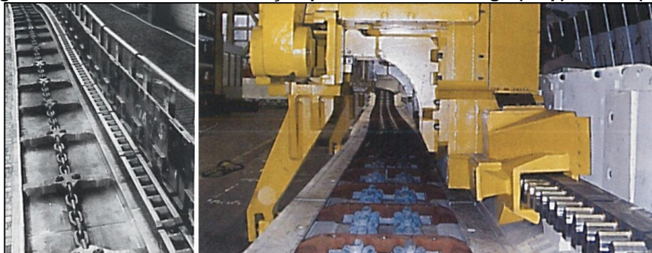
Figura 10 - Sistemas de alimentação por cremalheira antigo (esq.) e atual (dir.).
