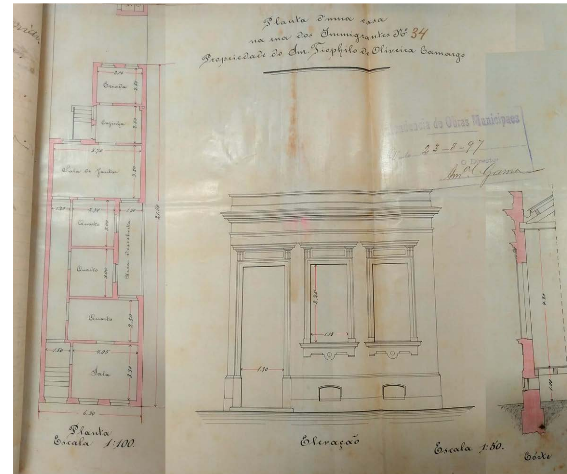
Figura 73 - Casa a construir na rua dos imigrantes nº34, propriedade de Tiophilo de Oliveira Camargo. Casa construída no alinhamento do terreno, com 6,30m de testada. O acesso da casa se dá por corredor lateral coberto, dando passagem à 3 quartos e sala de jantar. O acesso da sala da frente se dá pelo quarto. Os quartos e a sala de jantar possuem janelas voltadas para pequena área descoberta na lateral da casa. Fonte: Obras Particulares. Processo de 14/08/1897. AHMS/SP.
