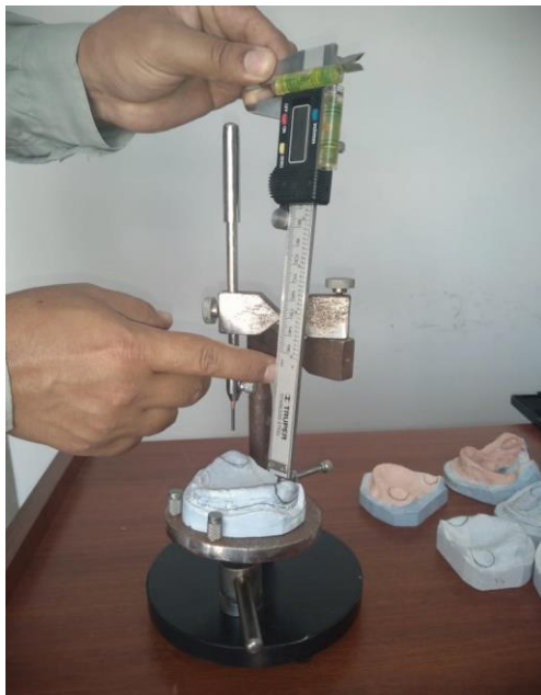
Luego con un calibrador Vernier digital (Truper®, digital estándar y milimétrico)
