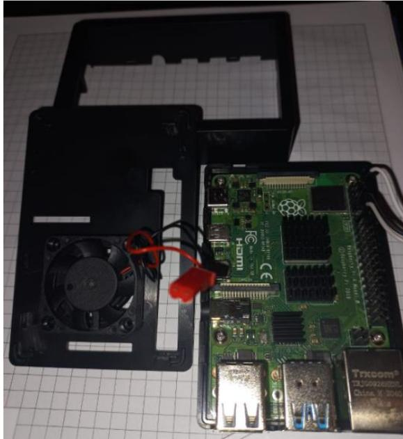
*Figura 46. Imagen del Ordenador de Placa Reducida Raspberry Pi 4
