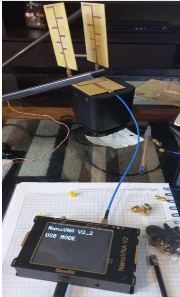
*Figura 31. Arrays de Antenas Log -Periódicas Fabricado con combinador y circuito captador de energía RF conector a NanoVna
