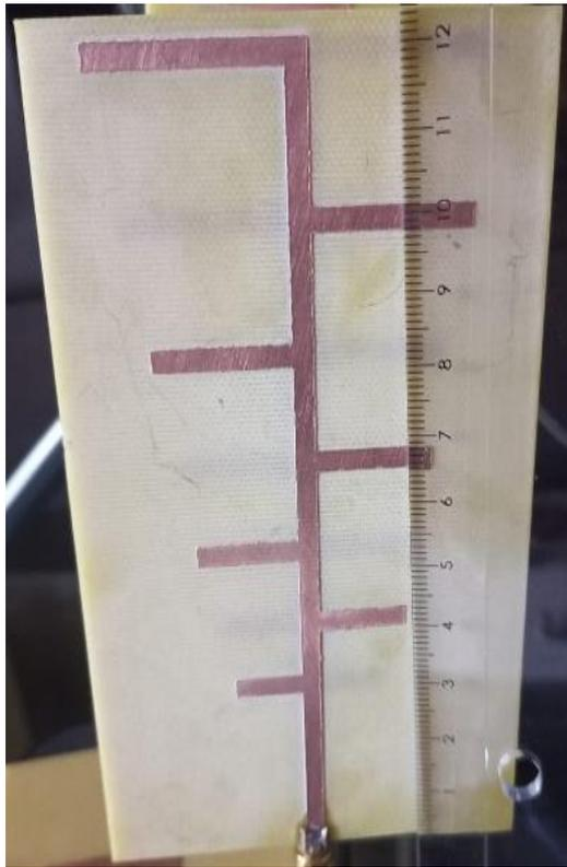
*Figura 27. Arrays de Antenas Log -Periódicas Fabricado
