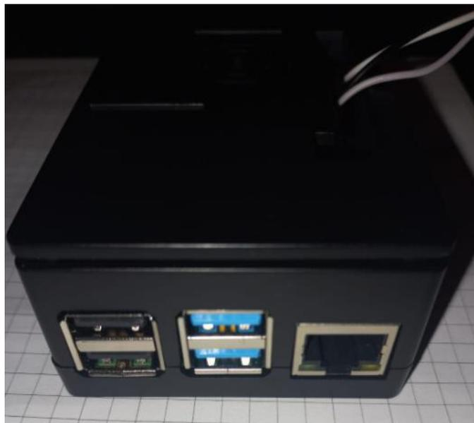
*Figura 47. Imagen del Ordenador de Placa Reducida Raspberry Pi 4 con su carcasa y acoplado su ventilador
