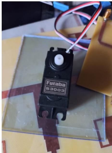
*Figura 33. Servomotor encargado de movimiento del array de antenas
