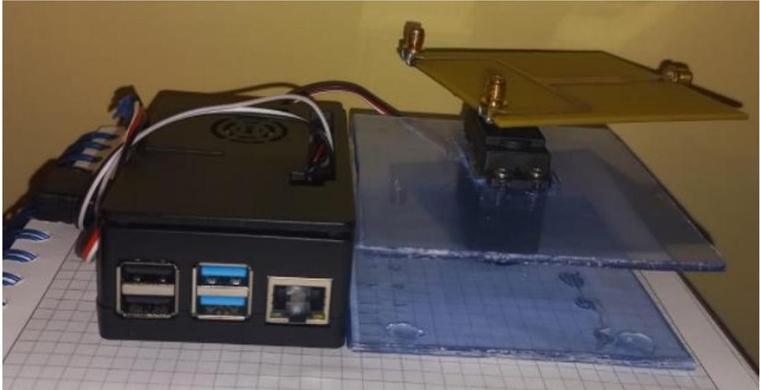
*Figura 48. Imagen del Ordenador de Placa Reducida Raspberry Pi 4 con su carcasa y acoplado su ventilador junto al servomotor con el combinador Wilkinson acoplado
