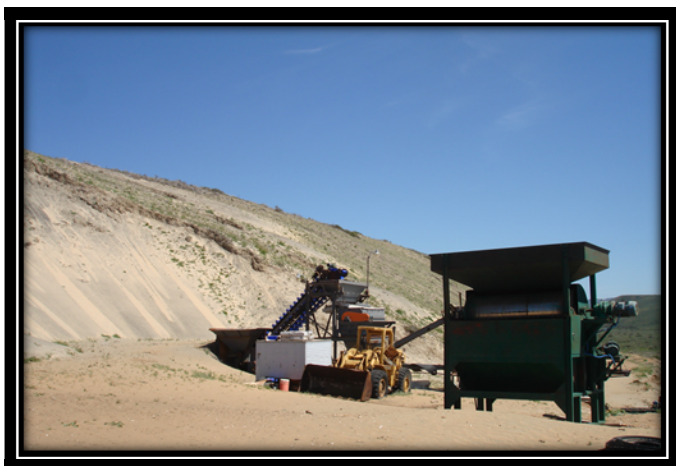
Figura 1. La fotografía muestra la zona en donde se efectuaba la extracción de arena por medio de máquinas donde separaban los minerales que contenían magnetita.
