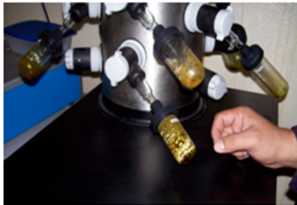
Figura 33. Liofilización de los extractos
