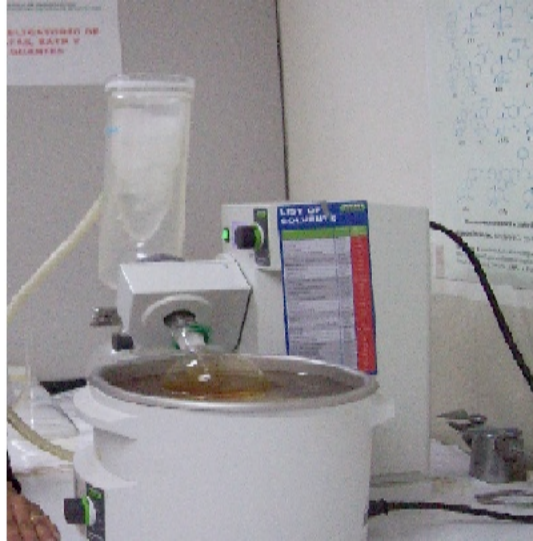
Figura 32. Eliminación del disolvente
