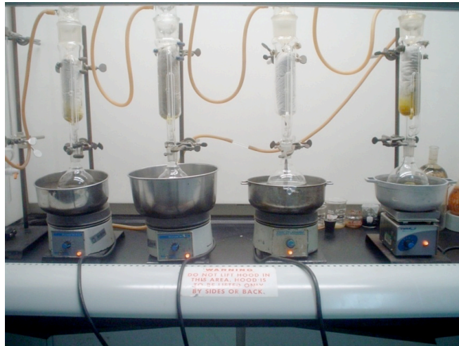
Figura 31. Sistema de extracción Soxhlet
