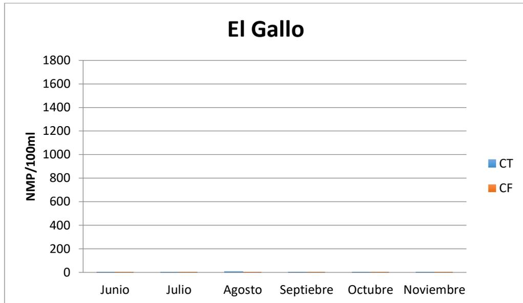
Figura 10. Valores de coliformes totales y fecales del efluente de salida de la planta de tratamiento de agua residual El Gallo durante los 6 meses muestreados en el año 2016.
