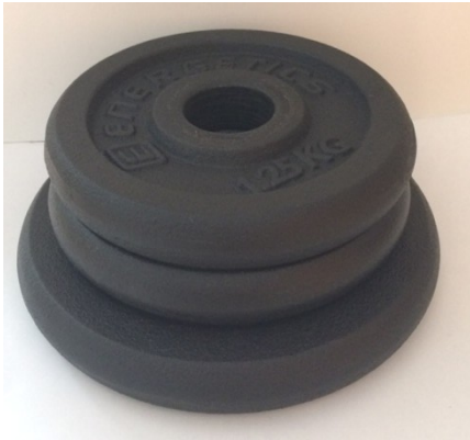
Abbildung 23. Gewicht für das Kondymeter. Gewichtscheiben: 2x 1.25 und 1x 3 Kilogramm
