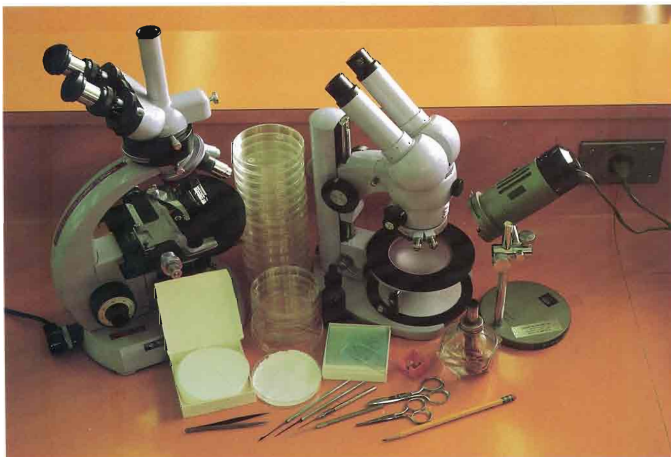
Figure 5. Le matériel nécessaire pour procéder à des examens en laboratoire comprend la loupe binoculaire, le microscope, les boîtes de Petri, le papier filtre, les pincettes, les aiguilles, le scalpel, une bouteille à compte-gouttes, des lames porte-objets et des lamelles couvre-objets.
