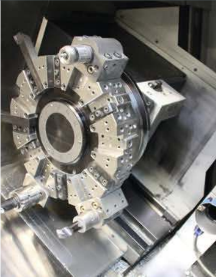
3 Auf der TL-Drehmaschine von CMZ wurde der servogesteuerte Reitstock gegen eine verfahrbare Späne-Blas-Saug-Düse ersetzt
