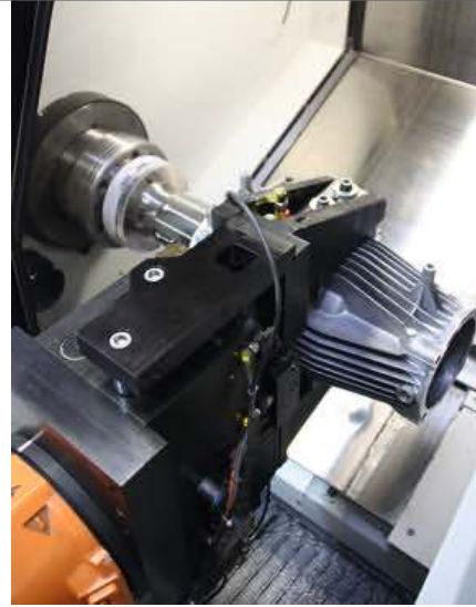
4 Einlegeteil: Das Motorgehäuse mit eingeschumpftem Ständerpaket wird vom Roboter auf die Spannvorrichtung gefädelt
