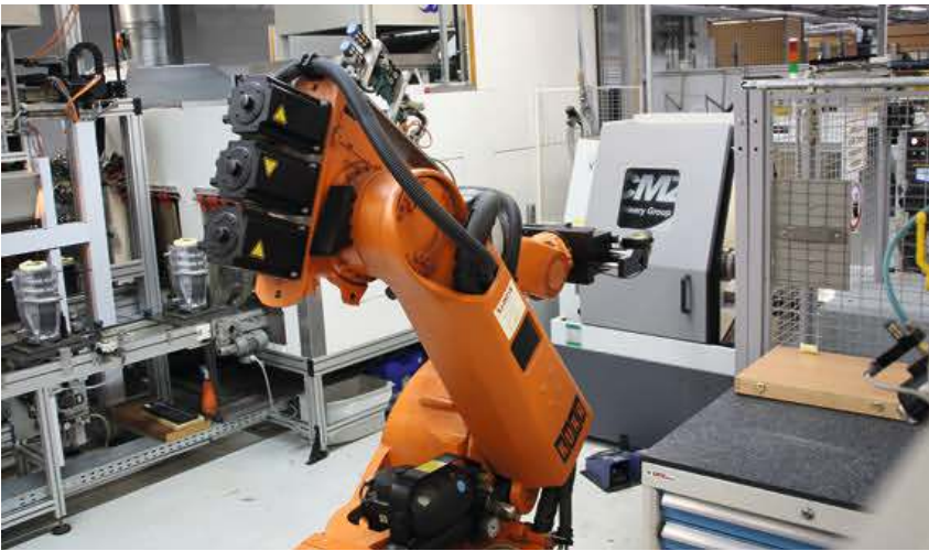
6 Zelle »Motorgehäuse«: Der Kuka-Roboter steuert die CMZ-Drehmaschine und schleust das bearbeitete Gehäuse für die Weitermontage direkt ans Montageband weiter
