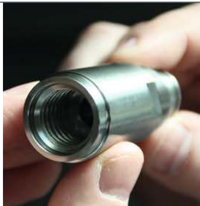
1 Zwei von 2000 verschiedenen Drehteilen, die auf den beiden TX-Maschinen von CMZ mit zwei Revolvern komplettbearbeitet und an die Montage geliefert werden
