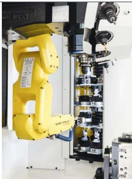
2 Maschinenraum mit Handlingroboter und Nullpunktspannsystem (links); Werkzeug-/Werkstückwechsel aus dem Karussell (rechts)
