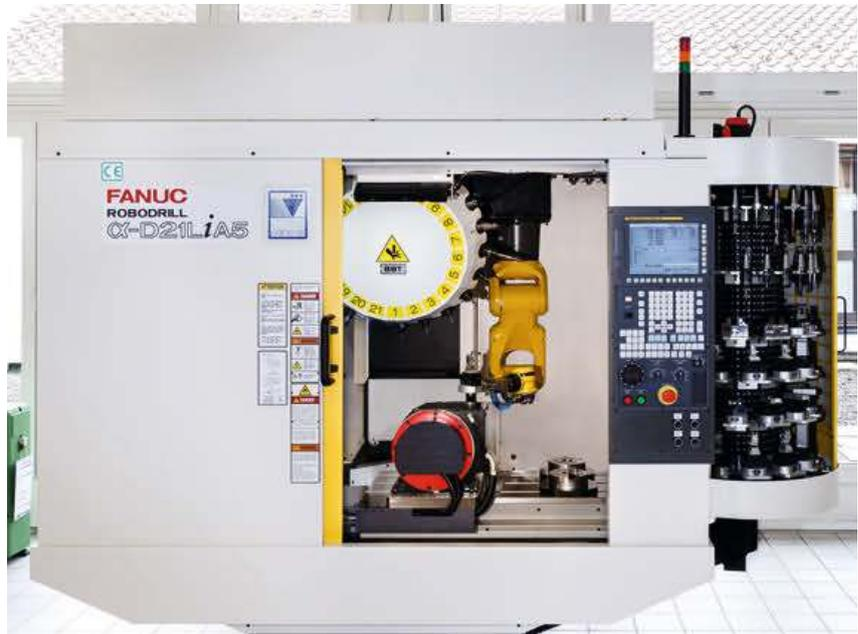
1 Kompakte und vollautomatisierte Produktionszelle von CNC Häberle, basierend auf einem Fanuc-BAZ Robodrill  $\alpha$ -D21LiA5 mit Fanuc-CNC und einem Fanuc-Roboter LR Mate 200iD; rechts das integrierte Speicherkarussell für Werkzeuge und Werkstücke
