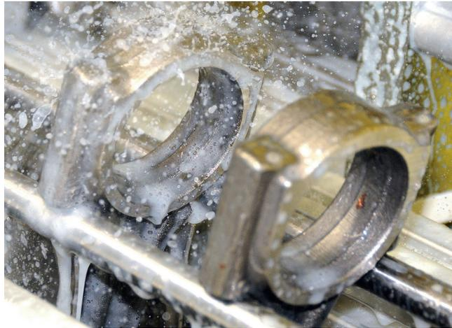
1 Wirtschaftliche Pleuelbearbeitung mit der Doppelplanschleifmaschine Saturn von Junker bei Linamar
