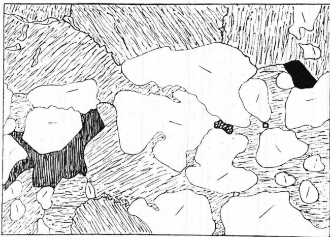
Fig. 14. Strukturbild af grågrön Ragundagranit, visande pertitens förhållande till kvartskornen. Pertiten streckad, kvartsen hvit med orienteringslinier. Till vänster ett biotitparti; till höger ett hornblende-, ett zirkon- och ett magnetitkorn. Omkr. \frac{1}{10} af nat. storl.
