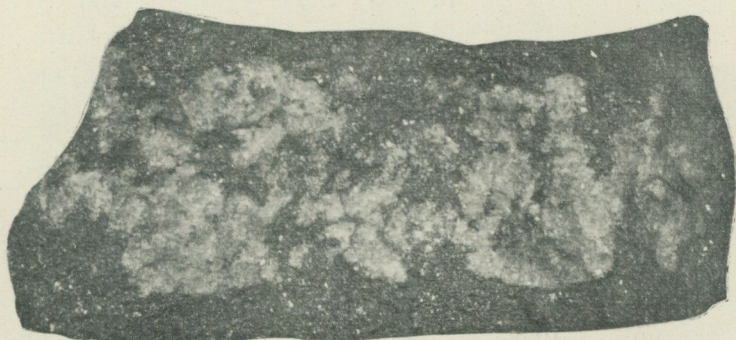
Fig. 4. Stuff av fältspatsten, färgad av mangansvärta. Porjusvare. Nat. storlek. De vita punkterna i de svarta partierna äro reflexer från fältspaternas genomgångsytor.
