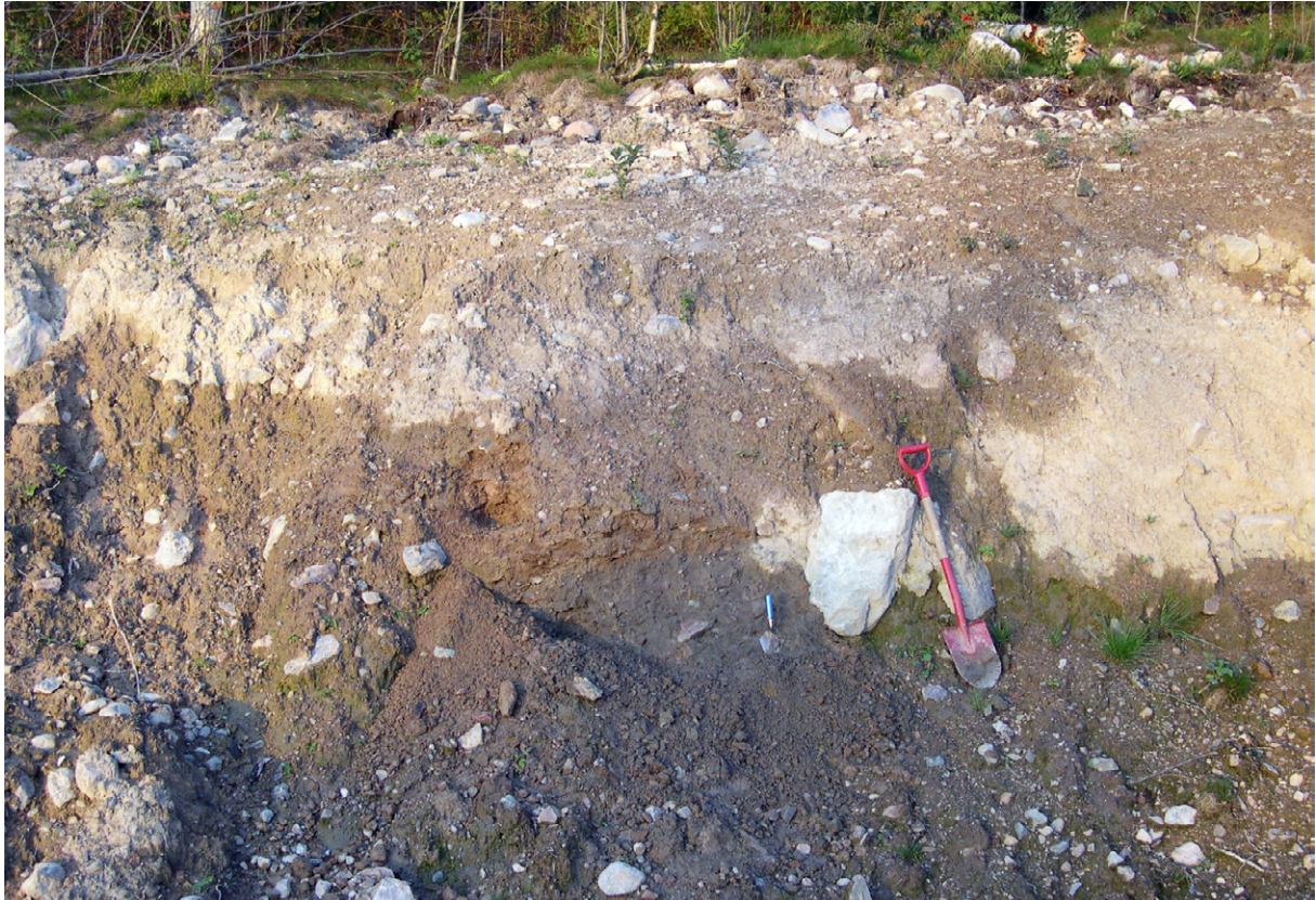
Fig. 10. Skärning som visar en sandig-siltig morän överlagrande en mörk lerig morän öster om norra Hemviken (4 g). Foto: B.-M. Ek
