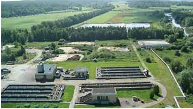
Figura 7. Sistema de fitorremediación que utiliza una plantación de 75 hectáreas de sauces en Enköping, Suecia. Planta de tratamiento de aguas residuales (primer plano), piletas para almacenar las aguas en invierno (al fondo) y campos de sauces regados con efluentes de fangos. P. Aronsson
