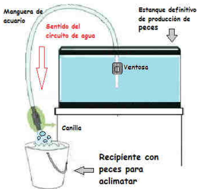
Figura 4: sistema de aclimatación mediante efecto sifón.
