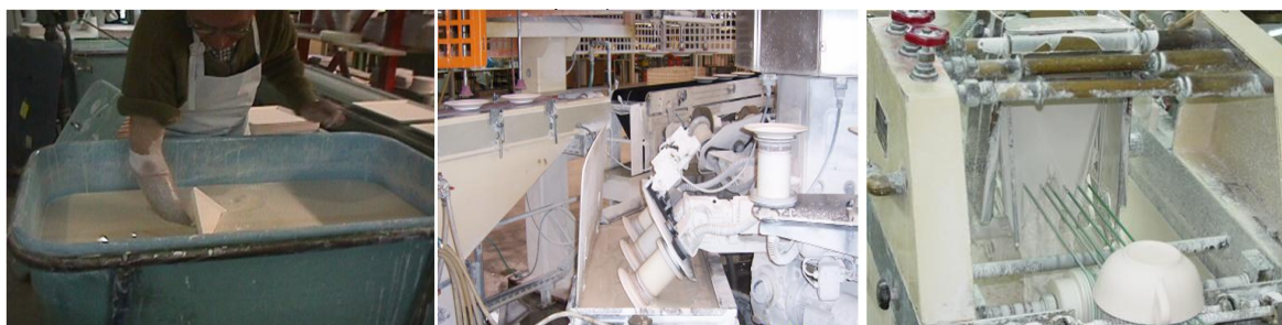
Figura 26 - Vidragem manual, de imersão automática e linha automática.
