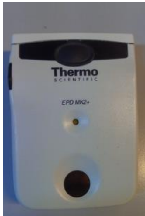
Figura 2.11. EPD Thermo Scientific modelo MK2+.
