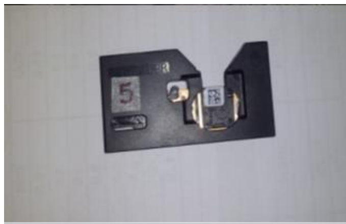
Figura 2.9. Adaptador porta dosímetro nanoDot con dosímetro montado.
