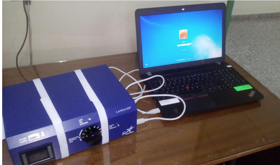
Figura 2.7. Lector microStar y PC acoplada.
