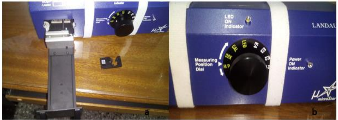
Figura 2.8. Gaveta abierta para insertar el dosímetro (a), perilla giratoria (b).
