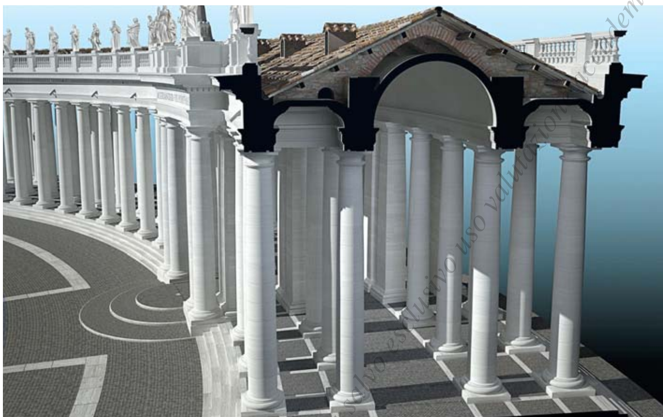
Fig. 79 - Colonnato di S. Pietro. Portico settentrionale, sezione dal basso (restituzione digitale dell'arch. C. Volken, in collaborazione con l'A.)
