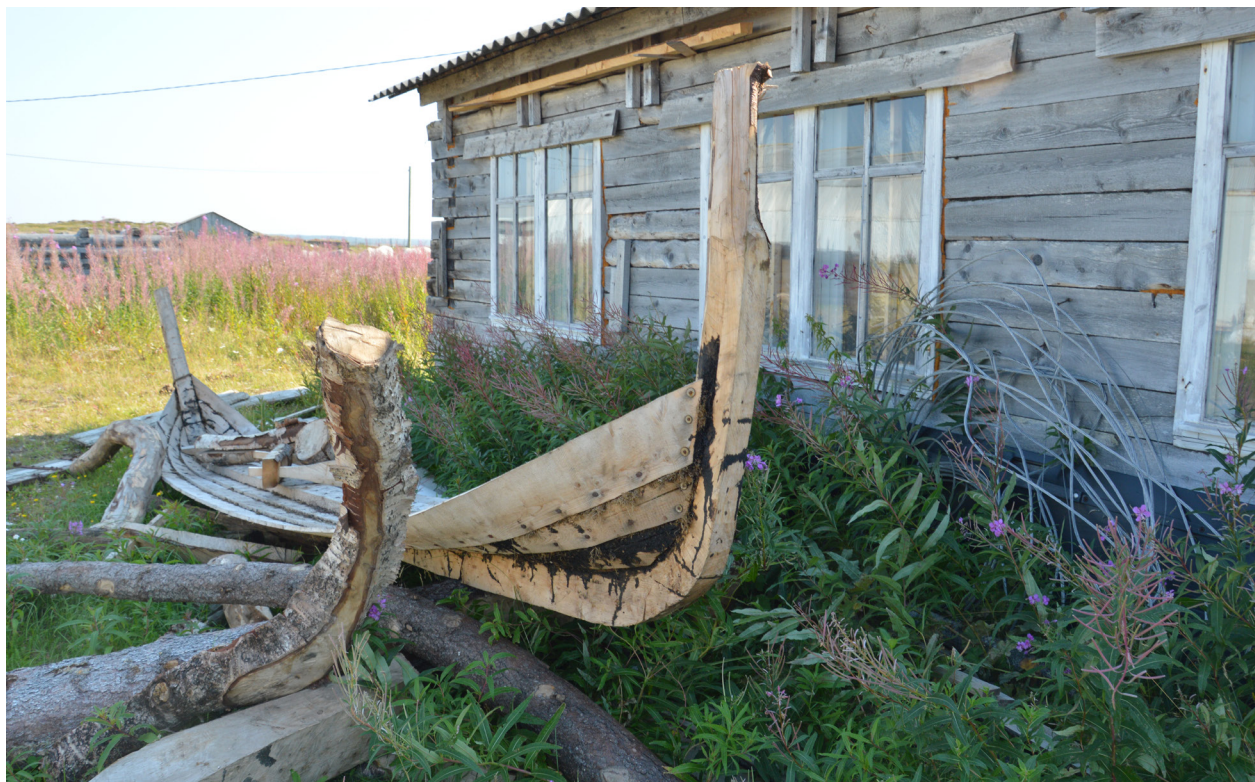
Рис. 13. Начальный этап шитья карбаса – создание киль (село Чаваньга)
