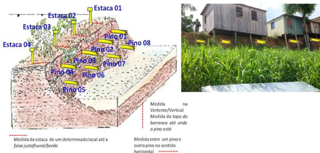
Figura 02 – Metodologia de Estaqueamento: Estacas nas horizontal e Pinos na Vertical
