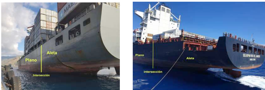
Imagen 77 y 78: Aletas poco idóneas para que el remolcador trabaje con seguridad
