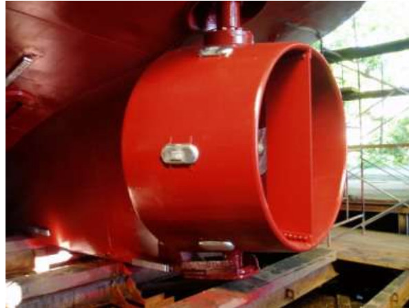
Imagen 34: Hélice montada en Tobera tipo Kort
