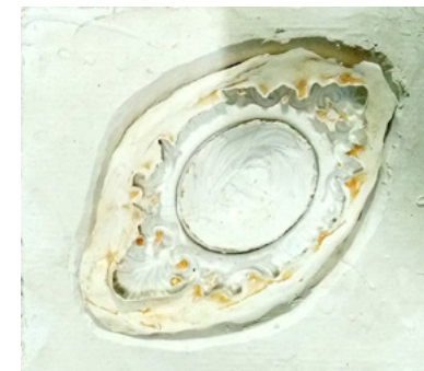
Imagen 12 - Procedimiento de realización de moldes con silicona
