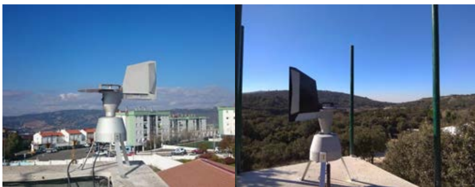
Figura 3.1. Captadores volumétricos de tipo Hirst instalados en Ronda (izquierda) y Sierra de las Nieves (derecha).
