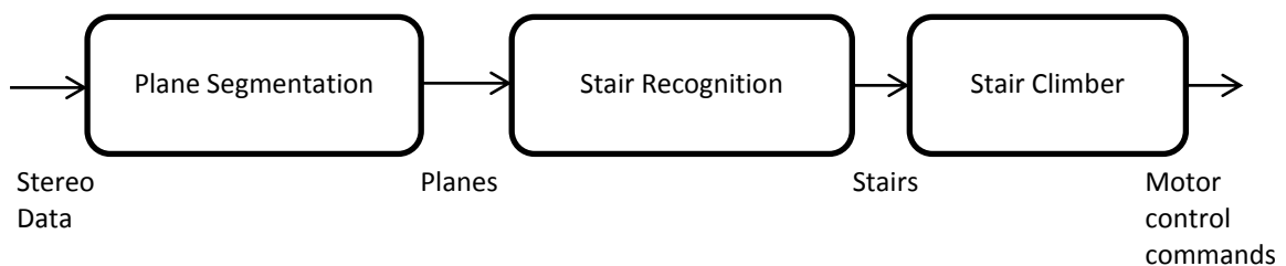
FIGURA 8. SISTEMA PARA RECONOCER Y SUBIR ESCALONES
