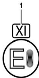
1 Marcaj pentru sticlă securizată laminată (exemplu)
